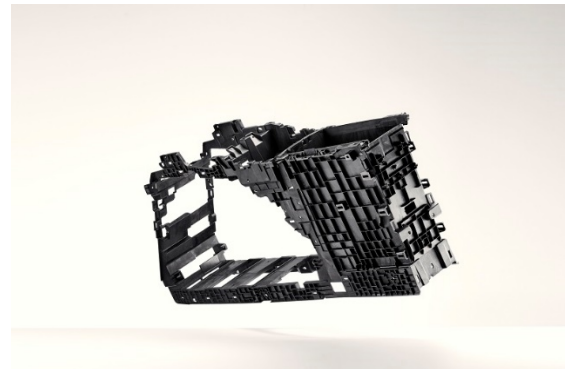
Foto: Ein Highlight der aus Materialien von Borealis und Borouge gefertigten Teile des NIO ES8 ist der Mittelkonsolenträger: Durch die Verwendung von Fibremod™ CB201SY, einem Ultraleichtmaterial der Fibremod™-Familie karbonfasergefüllter Polypropylen- (PP) Verbundstoffe, konnte das Bauteilgewicht um 20 % gesenkt werden. Foto: © Borealis
