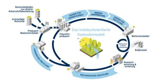
Grafik: Rückgewinnung von Kunststoff aus Kunststoff: Chemisches Recycling ermöglicht die Rückgewinnung von chemischen Rohstoffen aus Kunststoffabfällen, die sich sonst nur schwer mechanisch recyceln lassen – ein wichtiger Teil der Lösung bei dem Versuch, die Recyclingraten zu erhöhen und Plastikabfälle vor der Deponierung oder Verbrennung zu bewahren. Grafik: © Borealis
