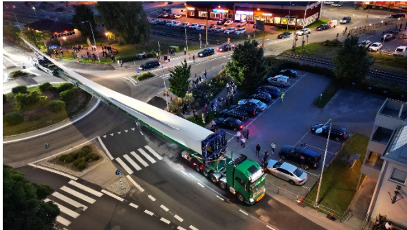
Specialkonvoj som transporterar vindturbinblad till vindkraftsparken Hultema i Sverige. Bilder copyright © Per Svensson Borrud
